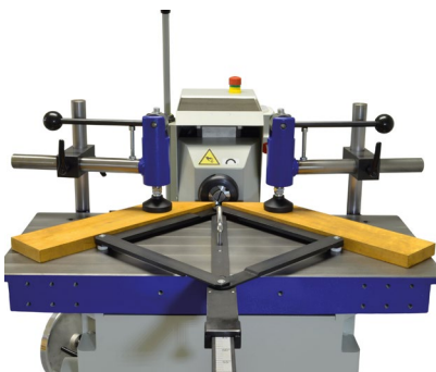
Doppelwinkelverstellanschlag für Winkel von 22,5° bis 75°
