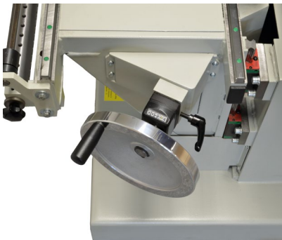
Höhenverstellung nach digitaler Anzeige auf 1 / 10 mm genau
