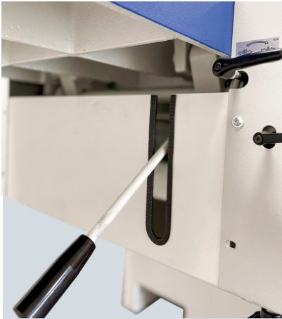
Manuelle Einstellung der Hohl- und Spitzfuge
