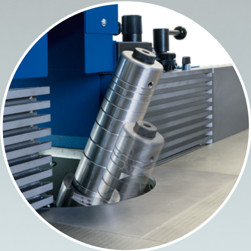
Höhenverstellung erfolgt linear über die Spindel
