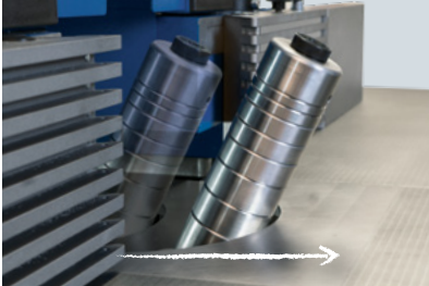
Tiefenverstellung erfolgt über die Spindel, nicht über den Fräsanschlag
