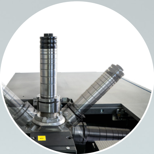
Schwenkbereich von -45,5^\circ bis +95,5^\circ
