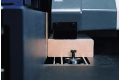
Bearbeitungsbeispiel T-Nuten Fräsen
