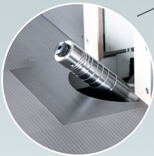
Tisch mit Tischschieber zur schnellen und optimalen Anpassung der Tischöffnung an das Werkzeug
