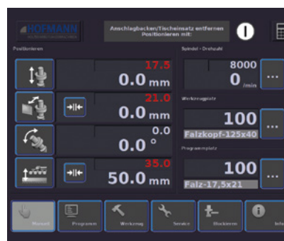
Beispiel Maske bei CNC-Steuerung
