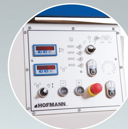
Motorische Verstellung für Höhe und Winkel
