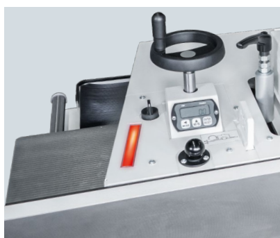
Sicherheitslichtleiste am Fräsanschlag
