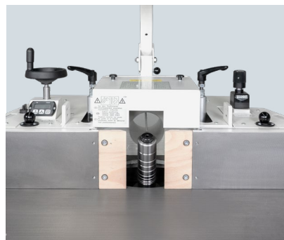
Fräsanschlag Typ 2620 mit Gussanschlagbacken, AIR-LOCK
